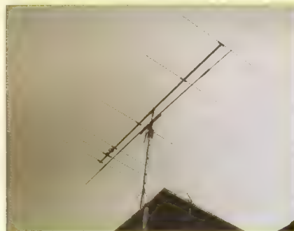
Een enkel element voor HF, met daarboven een 6 meter-antenne. Hier zal de invloed op de afstemming van de HF-antenne van de boom van de yagi goed merkbaar zijn. Andersom zal de invloed daarentegen nihil zijn.
